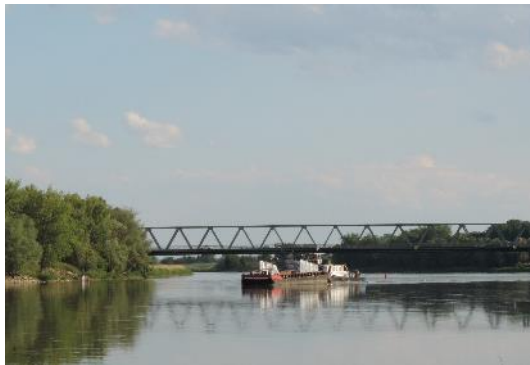
Foto 10: Nutzung der Oder als Bundeswasserstraße, hier beladener Schubverband bestehend aus Schubkahn und einem Leichter (Foto: STOWASSERPLAN)
