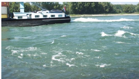
Foto 12: Schiffsantriebe verursachen je nach Getriebeart mehr oder weniger starken Wellengang (Foto: STOWASSERPLAN)
