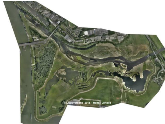
Foto 10: Renaturierung des Unterlaufs der Lippe als Zufluss des Rheins durch Verlegung des Gewässerverlaufs, Absenkung der Auenbereiche und Verfüllung von Abbaufächen zur Herstellung der Aue im Süden. Unter dem Einfluss des natürlichen Hochwassers von Lippe und Rhein sollen sich hier natürliche Auenwiesen entwickeln, die außerdem noch eine wichtige Funktion als Hochwasserrückhalteraum erfüllen können (Quelle: EGLV – EMSCHERGENOSSENSCHAFT UND LIPPEVERBAND 2015)
