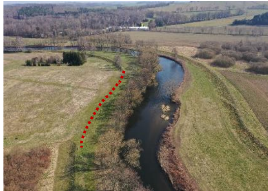
Foto 25: Durch Aufbrechen oder Schlitzten der Deichlinie können ehemalige Auen-, und Überflutungsflächen wieder erschlossen werden. (Foto: STOWASSERPLAN)
