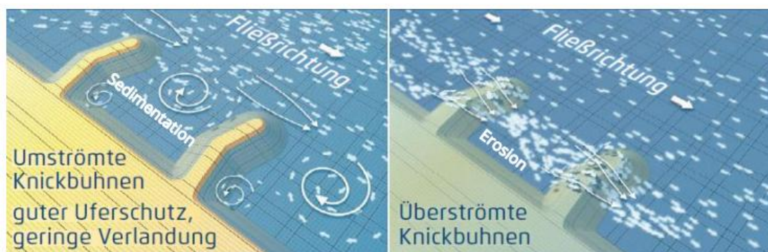
Abbildung 3: Knickbuhnen mit Darstellung der Strömungsmuster und deren Auswirkungen (Bundesanstalt für Wasserbau 2017)
