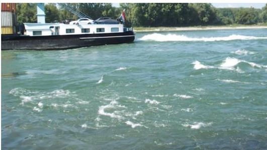
Foto 12: Schiffsantriebe verursachen je nach Getriebeart mehr oder weniger starken Wellengang (Foto: STOWASSERPLAN)
