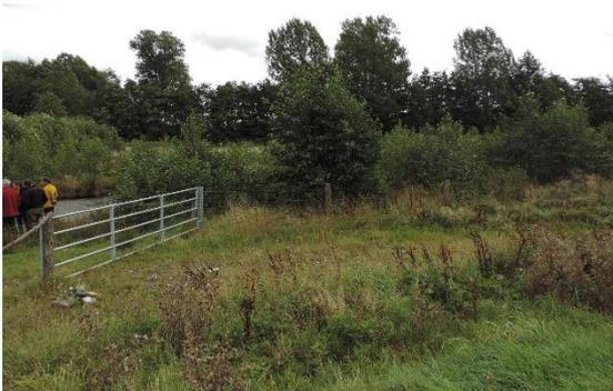
Foto 20: Landschaftsangepasste Zäunung außerhalb des Überschwemmungsbereichs und Kuhgitter im Bereich der Wegequerungen ermöglichen eine gute optische Einbindung und vermeiden Schäden an den Zäunen bei Hochwasser. (Foto: STOWASSERPLAN)
