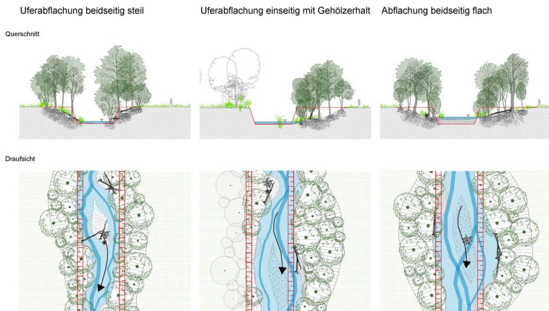
Abbildung 7: Möglichkeiten der Profilaufweitung: Links mit beidseitiger Uferabflachung, Mitte einseitige Aufweitung, Rechts beidseitige Aufweitung. (Grafik: STOWASSERPLAN)
