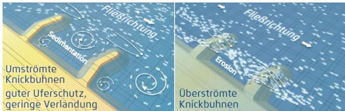
Abbildung 6: Knickbuhnen mit Darstellung der Strömungsmuster und deren Auswirkungen (Bundesanstalt für Wasserbau 2017)
