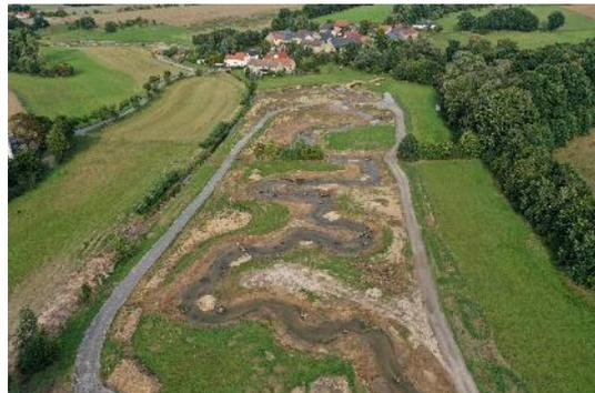
Foto 32: Nach den Erdarbeiten zur Profilmodellierung werden noch punktuell Abweiser, Faschinen, Setzstangen und Wurzelstüben zur Strukturierung eingebaut. (Foto: STOWASSERPLAN)
