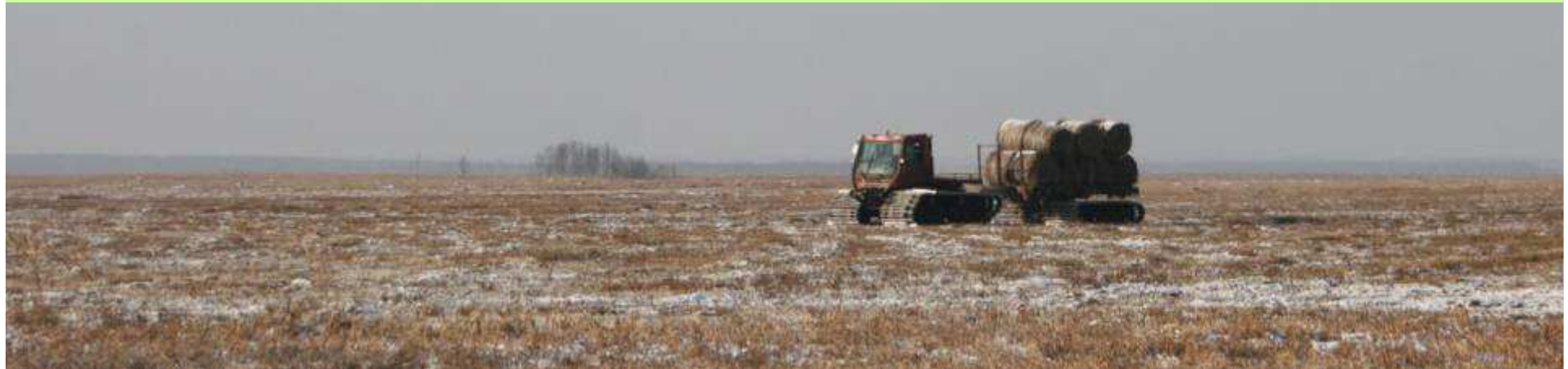
■ Na zdjęciu: załadunek bali specjalnym chwytakiem. Konstrukcja ta została zaprojektowana z dźwigu do załadunku drewna.
