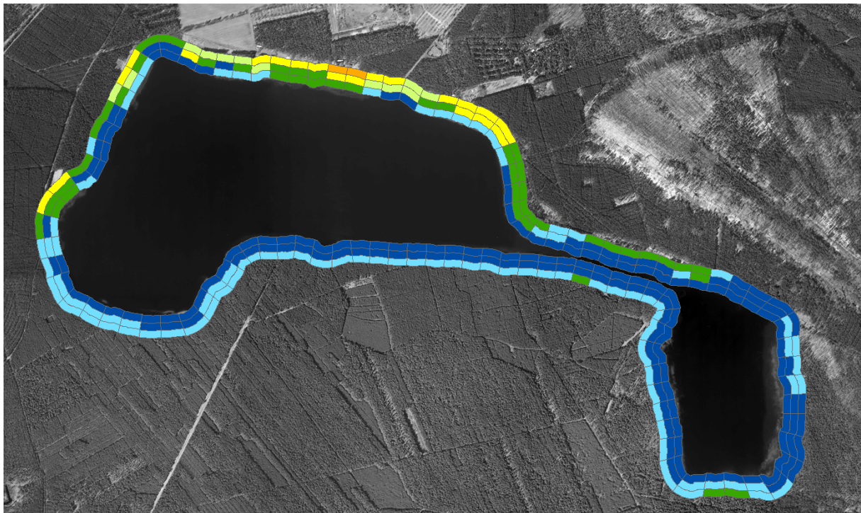
Abbildung 69: Hydromorphologische Veränderungen des Helene-/Katjasee-Ufers in den Subzonen „Epilitoral“, „Eulitoral“, „Sublitoral“. Dargestellt sind die Mittelwerte des HMS-Belastungsindex. Die Darstellung ist nicht lage- bzw. maßstabgenau; Farbgebung: Tabelle 28.
